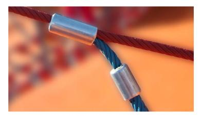
Tek parça alüminyum döküm konektörler, ipin hareket etmesini ve erken aşınmayı önlemek için 300 ton pres ile sıkıştırılmıştır. "Sonlandırıcı konektör" keskin açı veya kenarlar bulundurmaz ve iyi bir kavrama sunar. Bu konektörlerin ana çerçeveye bağlantısı kaynaklı flanşlar ya da "C" alüminyum kelepçelerle yapılır.
