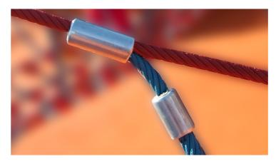
Tek parça alüminyum döküm konektörler, ipin hareket etmesini ve erken aşınmayı önlemek için 300 ton pres ile sıkıştırılmıştır. "Sonlandırıcı konektör" keskin açı veya kenarlar bulundurmaz ve iyi bir kavrama sunar. Bu konektörlerin ana çerçeveye bağlantısı kaynaklı flanşlar ya da "C" alüminyum kelepçelerle yapılır.
